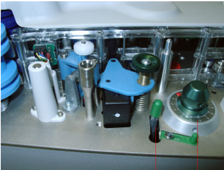
Bild 3–4 1 Verriegelung- Separator 2 Separator-Justage (Seitliche Kerbe markiert die Einstel- lung des Separators)
