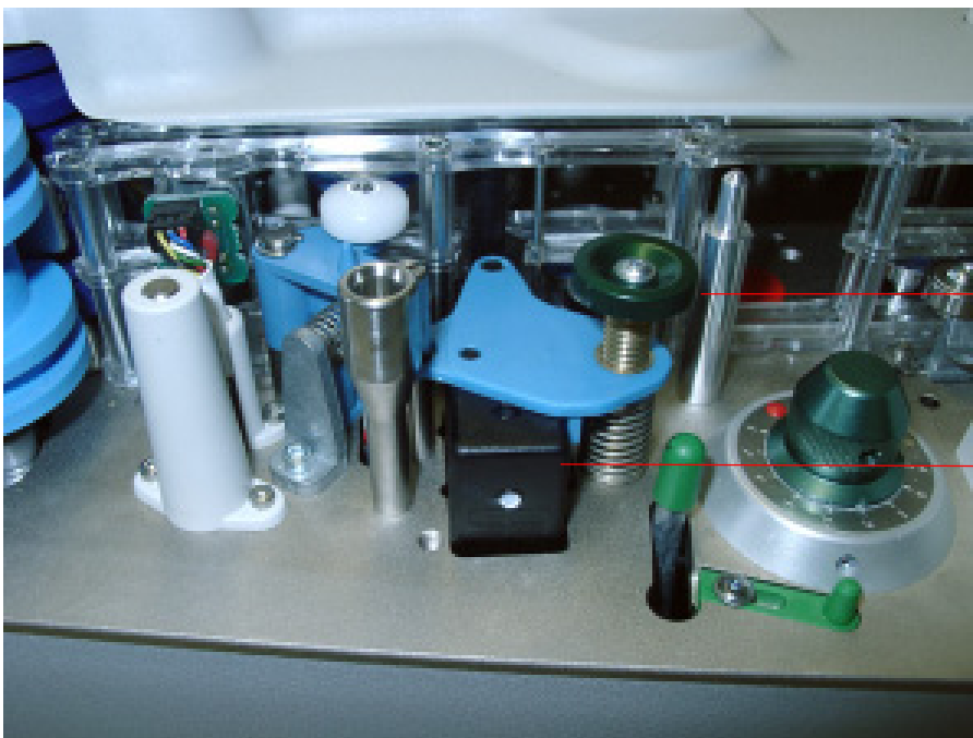
Bild 3-1 1. OCR Justageknopf 2. OCR Kopf
