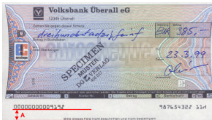
Bild 3–3 OCR-A Vorgabewert a = 9 mm
