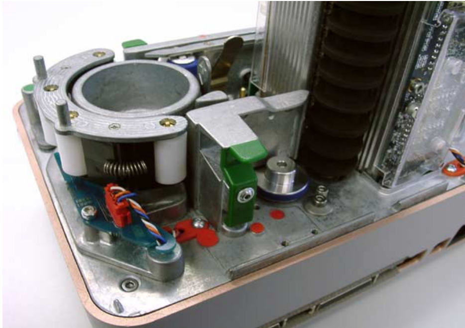
Bild 2-10 1 Leitblechgriff (grün) 2 Seitenblech
