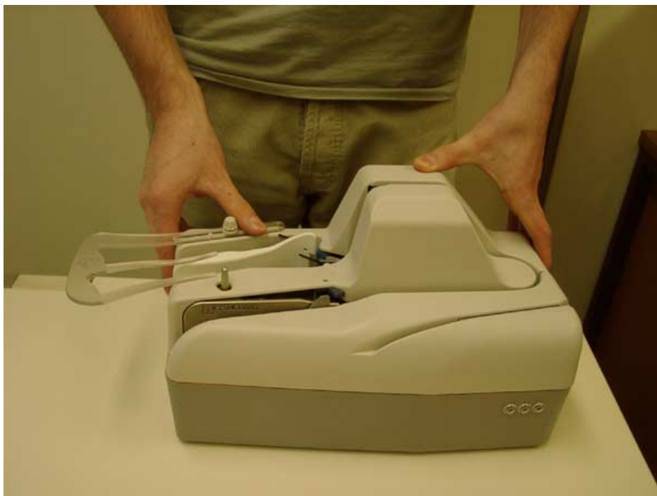
Bild 2–3 Die Abdeckungen werden abgenommen, indem Sie mit beiden Händen die Längsseiten festhalten und gleichzeitig nach oben ziehen.
