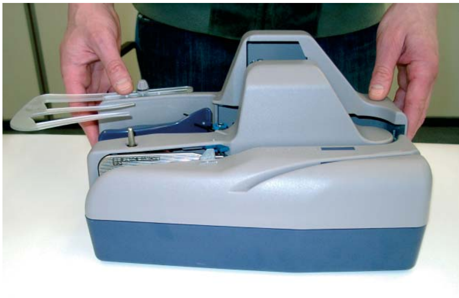
Bild 2–3 Die Abdeckungen werden abgenommen, indem Sie mit beiden Händen die Längsseiten festhalten und gleichzeitig nach oben ziehen.
